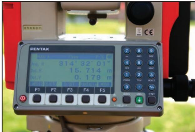
Estación total para levantamiento topográfico.
