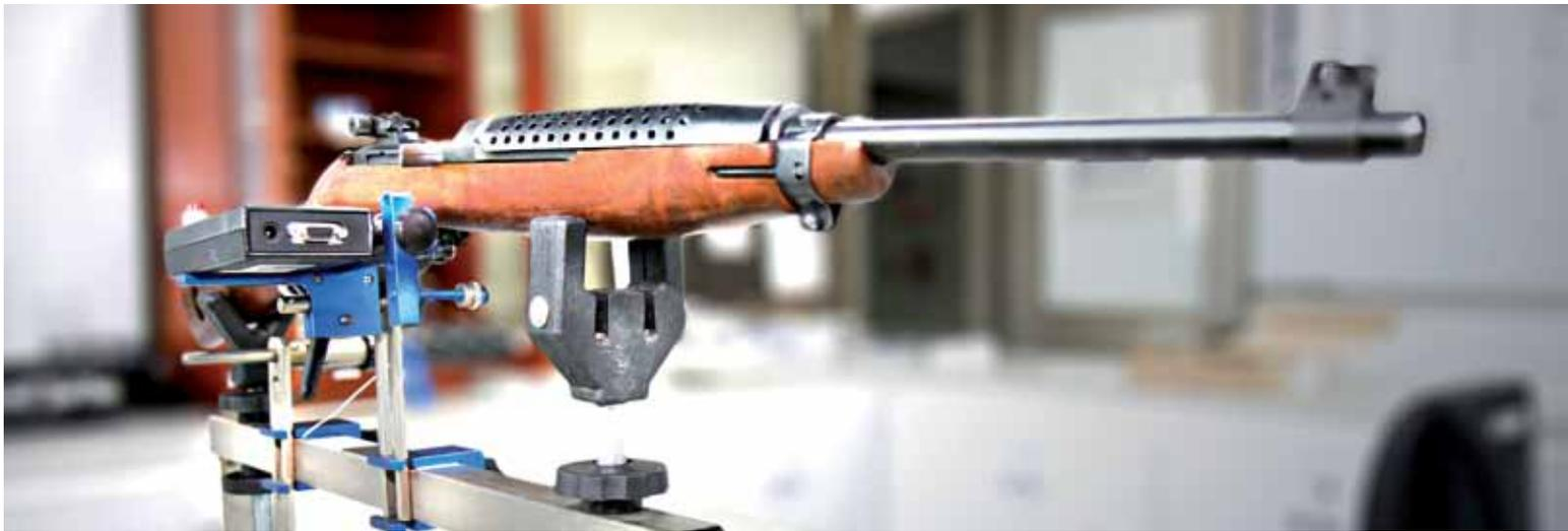
El dinamómetro mide la fuerza que se requiere para accionar un arma. Este fue uno de los ensayos acreditados del Laboratorio de Balística del Nivel Central.
