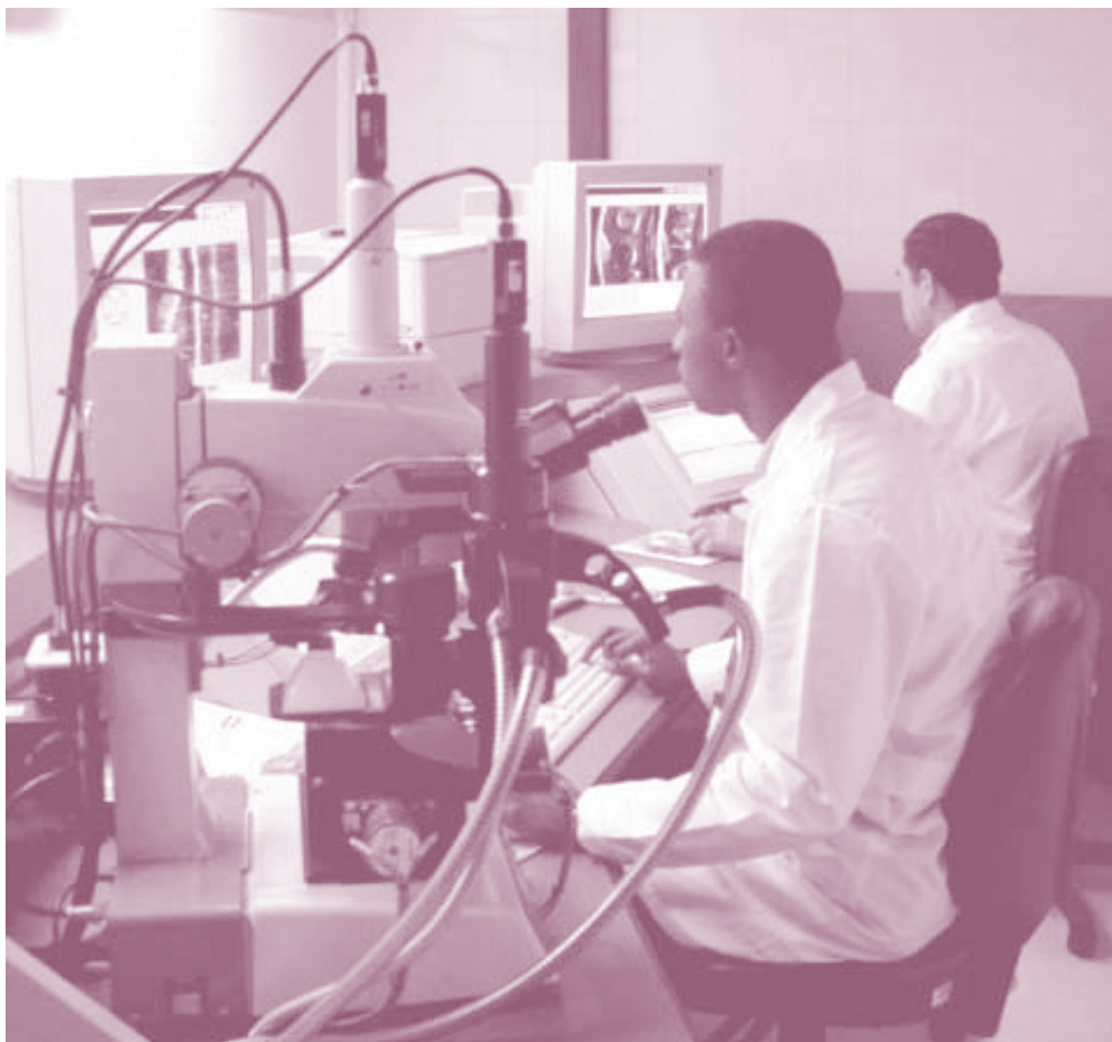
▲ Sistema integrado de identificación balística, "IBIS", donde se realiza la correlación de vainillas y proyectiles, ingresados a la base de datos, correspondientes a diferentes hechos.
